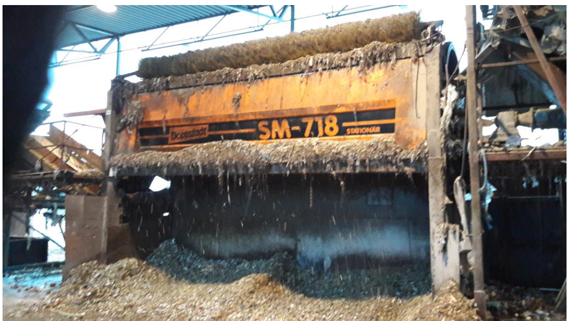
Kuva 1 Rumpuseulan alta tippuvaa rakennusjätteen alitetta
